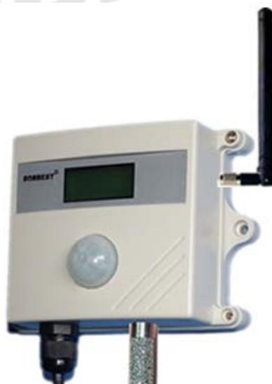
SZ219 光照度传感器为 ZIGBEE 无线总线式光照度及温湿度一体式传感器，采用 ZIGBEE 无线，标准 MODBUS-RTU 协议，可实现多点同时监测，组网并远传。
