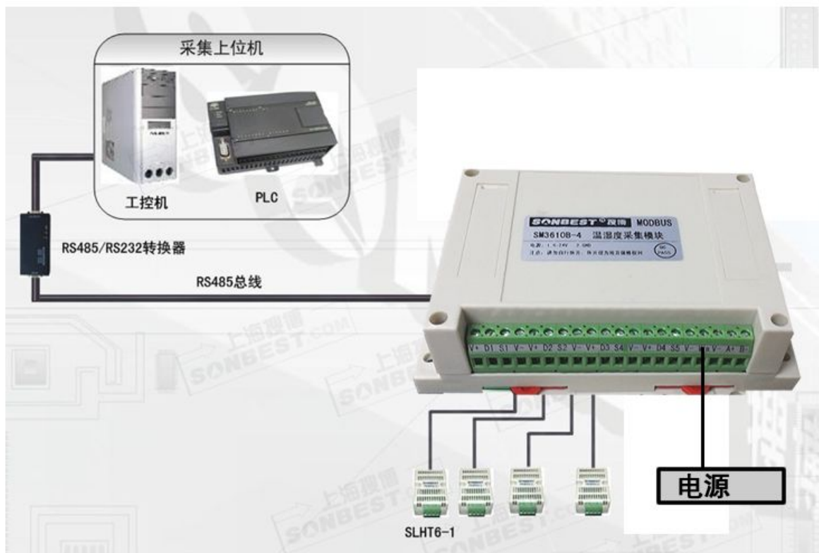
图 1.1 测温湿度原理示意图
