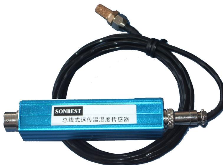
**SM1410C** 温湿度传感器，配合美国瑞士专用温湿度传感器，基于工业用 MODBUS-RTU 协议，实现低成本温湿度状态在线监测的实用型一体化模块，
