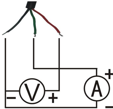
电源电压输入 电流4-20mA输出
