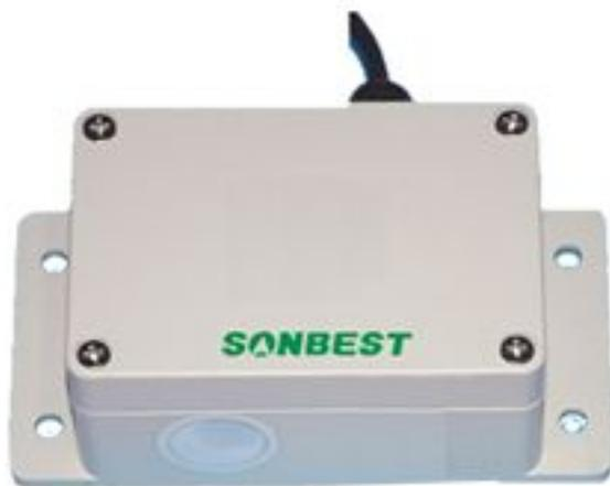
**SM3370B RS485 红二氧化碳、光照度、温度、湿度一体传感器为 RS485 总线式传感器，是针对农业生产过程中环境监测而设计的专用传感器，内置核心传感器全部为进口器件。仪器能够连续监测二氧化碳气体浓度、光照度及环境温湿度等 4 种环境参数，每个参数值都转换成 MODBUS-RTU 标准 RS485 电信号传输给关联设备，本传感器内置了报警接口，可选配超限声光报警设备。**
