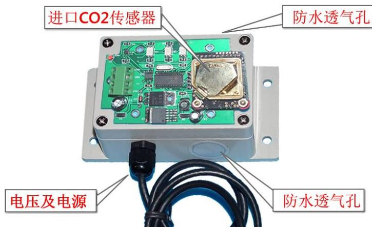
如上图所示，产品由进口红外 CO<sub>2</sub> 传感器、气体检测气窗（孔）及防水接头等几部分组成。
