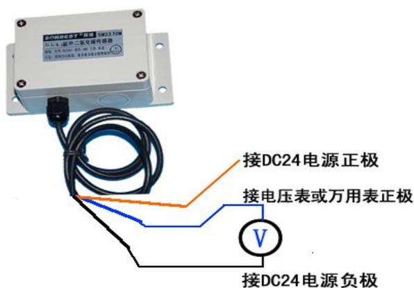
本设定的 CO<sub>2</sub> 检测量程为 0-5000ppm，那电流与 CO<sub>2</sub> 的关系如下表所示：若，CO<sub>2</sub> 满量程记为 C<sub>A</sub>，读出的电流电压值为 V<sub>R</sub>，那实际对应的 CO<sub>2</sub> 浓度值 C<sub>R</sub> 为：
