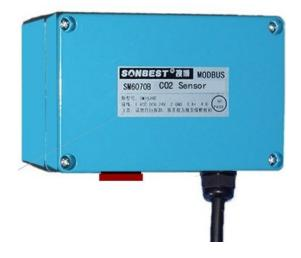
SM6070B2 工业型红外二氧化碳(CO2)传感器为 RS485 总线式 CO2 传感器,是 一种专门用以监测二氧化碳气体的本质安全型检测仪表。仪器能够连续监测二氧化碳 气体浓度并远程显示,同时将浓度值转换成 MODBUS-RTU 标准 RS485 电信号传输 给关联设备, SM6070B2 还带有报警功能。
