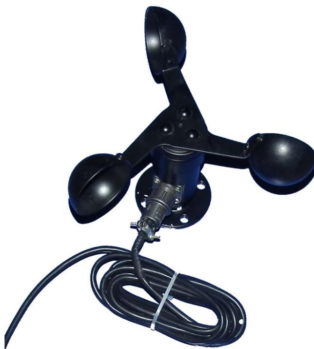
SM5385B 工业型风速传感器为 RS485 总线式传感器，是一种专门用以监测风速的检测仪表。仪器能够连续监测风速并远程显示，同时将风速转换成 MODBUS-RTU 标准 RS485 电信号传输给关联设备。
