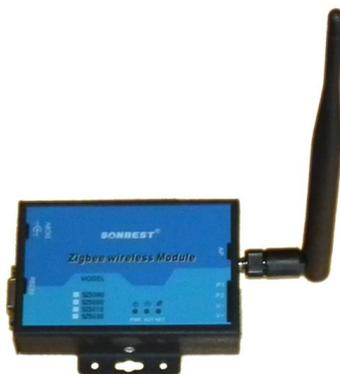
配套 ZIGBEE 数据采集终端的型号为 SZ5090,一个 SZ5090 理论上可以 65535 个 SZ2000C 组建 ZIGBEE 网络。下图为典型应用方案。
