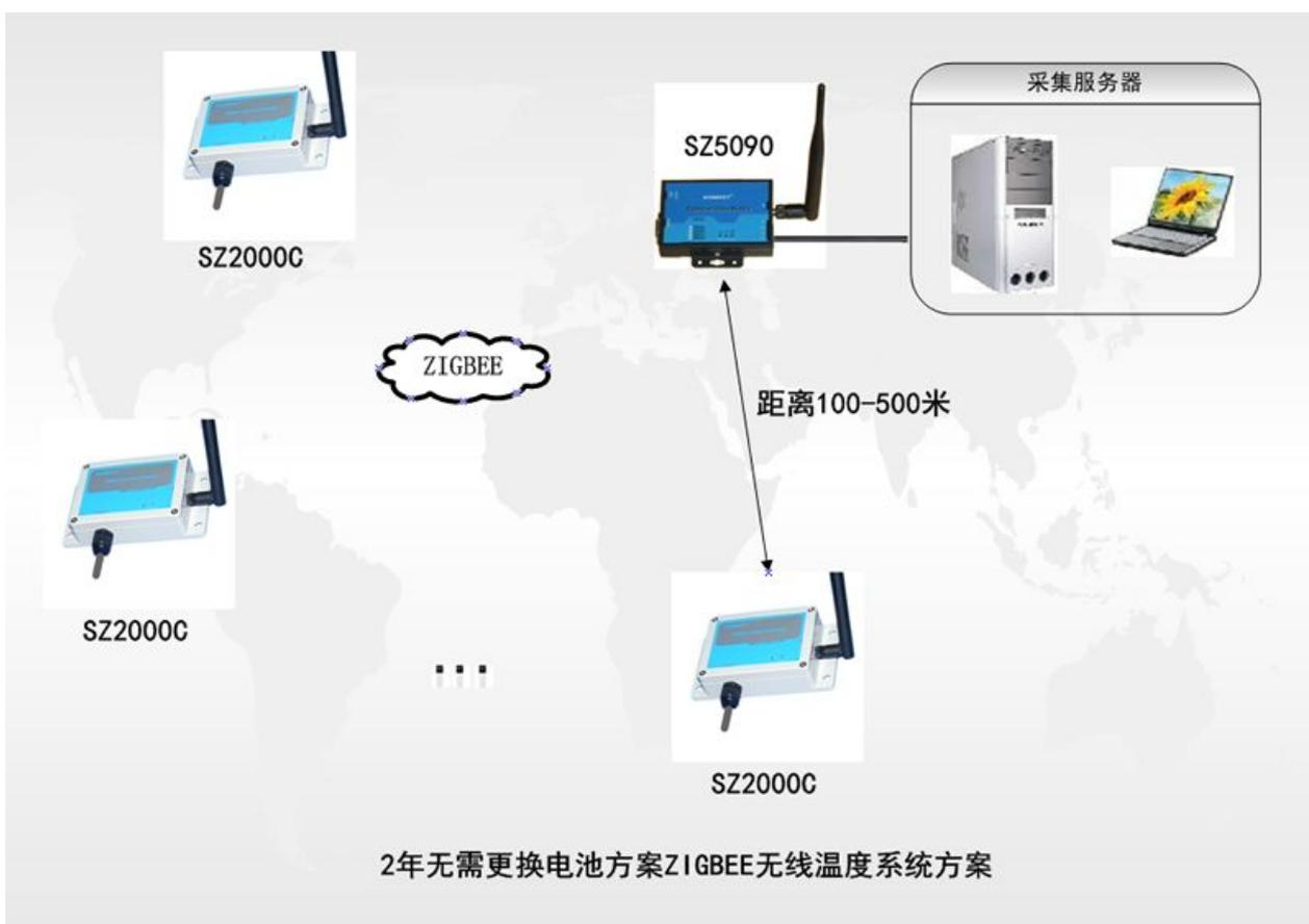
本方案可应用于“生产车间环境温度监测系统”、“大棚环境温度监测系统”、“煤壁煤场测温系统等各种需要温度监测的场所。
