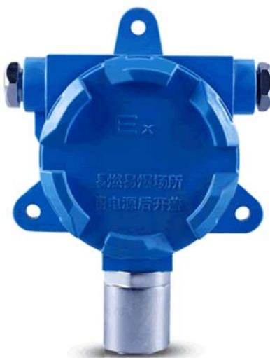
**SM6030B 防爆型红外二氧化碳(CO2)传感器为 RS485 总线式 CO2 传感器**，是一种专门用以监测二氧化碳气体的使用防爆外壳的检测仪表。仪器能够连续监测二氧化碳气体浓度并远程显示，同时将浓度值转换成 MODBUS-RTU 标准 RS485 电信号传输给关联设备。
