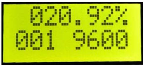
如上图所示，显示器共分为2排，上排显示土壤水分显示仪值，下排显示通讯信息，9600为波特率，下排右侧显示内部模块的电压值，用于指示设备工作状态，用户可以不用理会。当设备地址拨码开关更改时，新的设备地址也会在显示器上自动显示。
