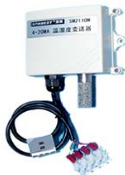
SM2110M-2 温湿度电流变送 (含工业防护传感器)
