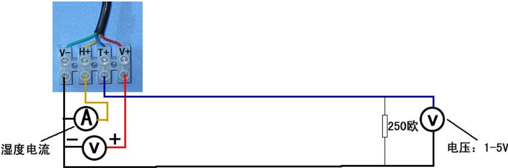
电流远传电压检测接线方式
