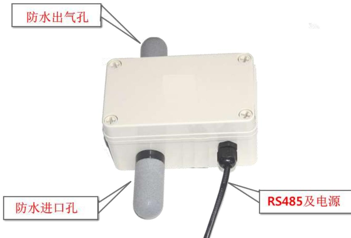
如上图所示，产品由红外 CO<sub>2</sub> 传感器、温湿度传感器、气体检测气窗（孔）及防水接头等几部分组成。
