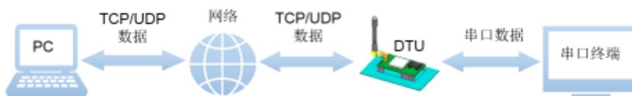
在此模式下，用户的串口设备，可以通过本模块发送数据到网络上指定的服务器。模块也可以接受来自服务器的数据，并将信息转发至串口设备。
