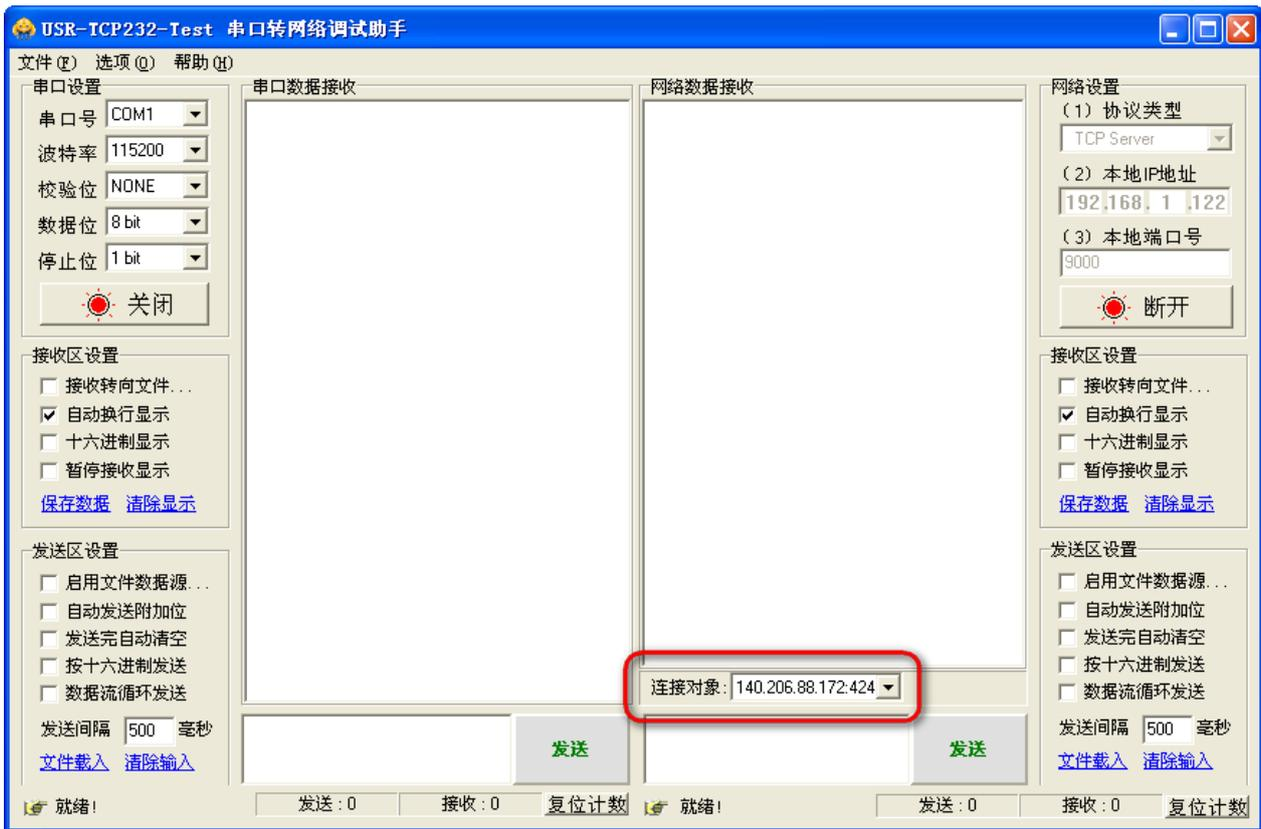
发送串口数据会在网络数据接收窗口显示；发送网络数据会在串口数据接收窗口显示。
