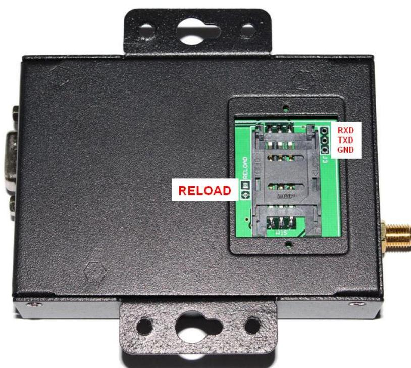
背面为：SIM 卡插槽；RELOAD 接口（通电工作状态下，短接 1 秒恢复默认设置，短接 3 秒以上恢复出厂设置）；固件升级接口。
