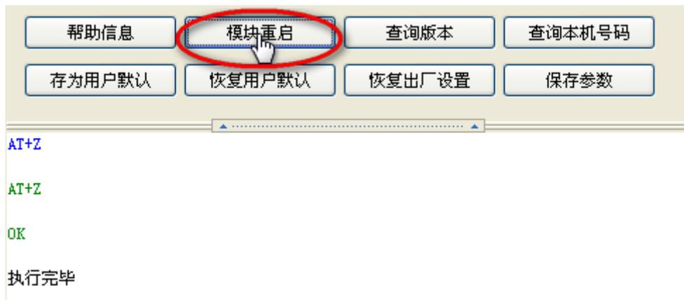
待下方进度条走完和显示执行完毕后，模块重启，设置完毕，
