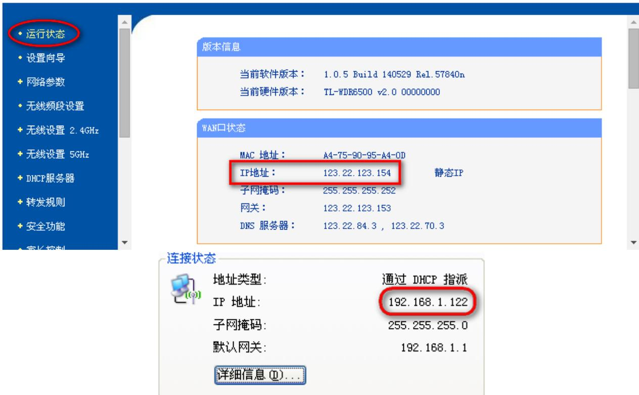
然后设置端口和 IP 地址：外部端口为模块设置端口，内部端口为本地计算机的端口，IP 地址为本地计算机的 IP 地址。
