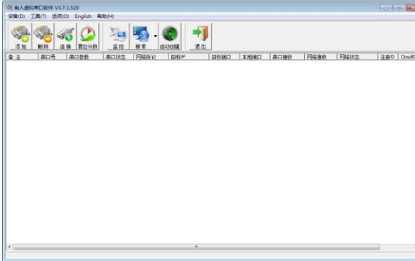
将下图中 虚拟串口选择未用串口 本地端口更改为自己设置的端口
