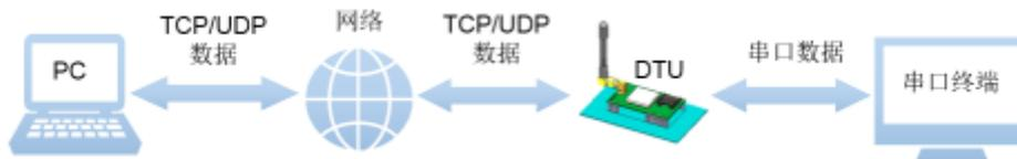
在此模式下，用户的串口设备，可以通过本模块发送数据到网络上指定的服务器。模块也可以接受来自服务器的数据，并将信息转发至串口设备。
