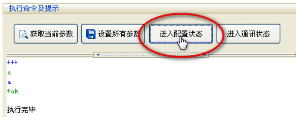
显示以上内容表示已进入配置状态，可以先获取当前参数进行修改，也可以直接修改参数设置。
