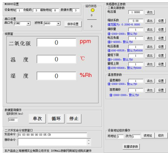
2、点击读地址后串口接收数据返回 01 25 01 01 D0 43 如下图说明 KG50B3990 已连接到软件
