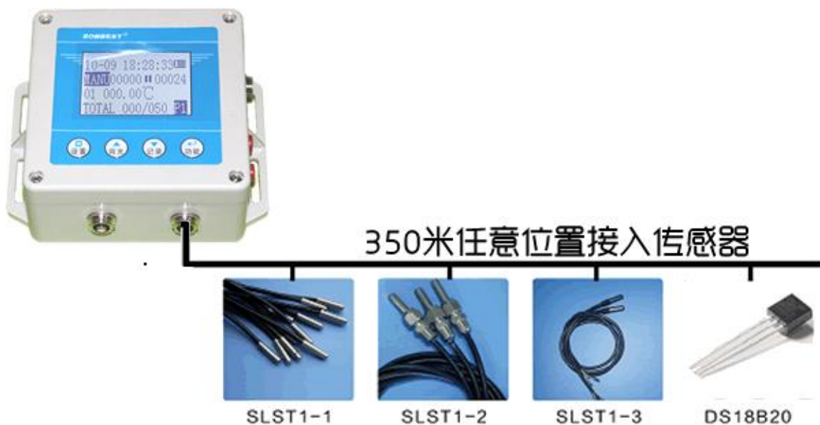
图 4. 1. 1 SR1000 温度记录仪基本接线方式
