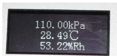
显示器分三排显示 3 个状态量，第一排为大气压力，第二排为温度，第三排为湿度。
