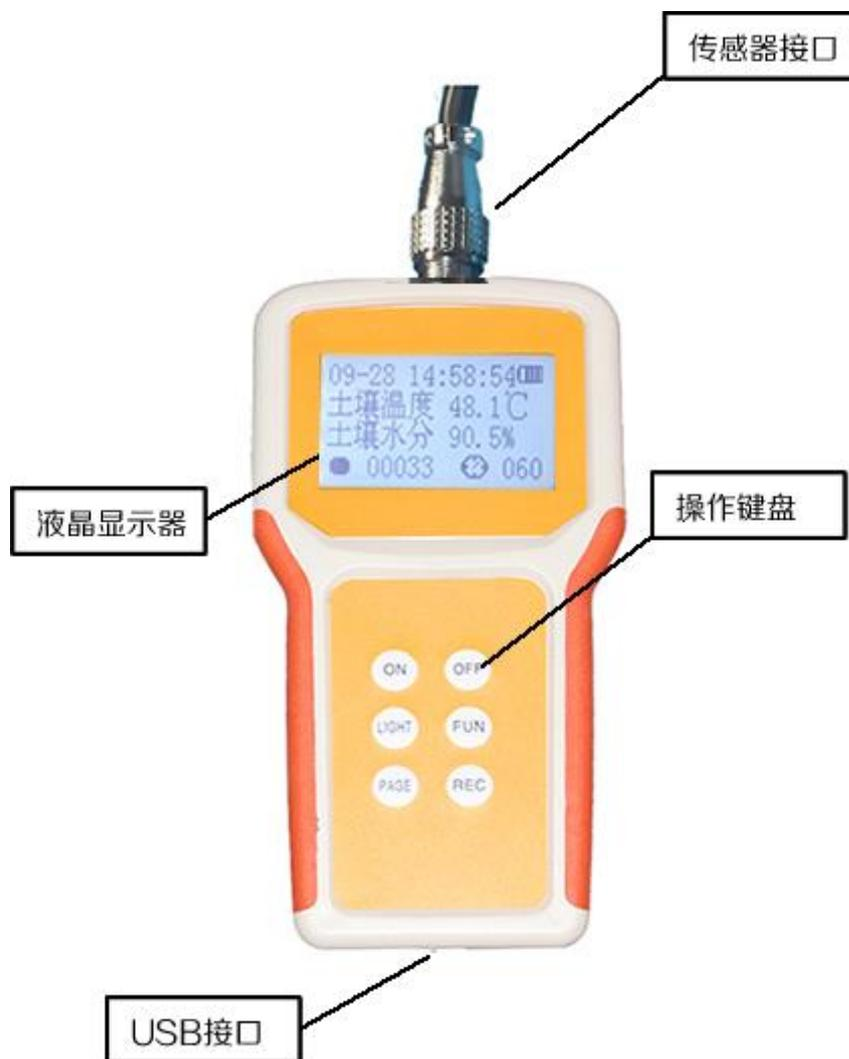
如上图所示，设备由传感器接口、USB 通讯接口、大屏幕 LCD 显示器、键盘等几部分组成。
