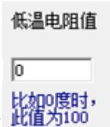
写入 0 度时对应的分度表里的电阻值 100; 在
