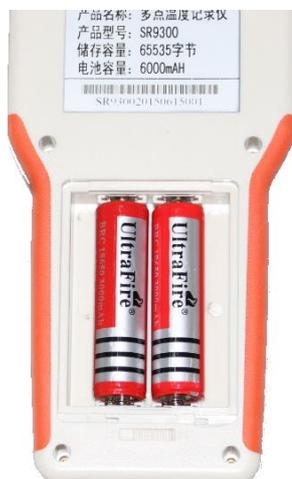
电池置于设备背面，需打开后盖，即可以看到锂电池。电池安装时，请注意先将电池后端塞入电池槽，然后压上部铜片接触部分，最后再盖上电池盖板。
