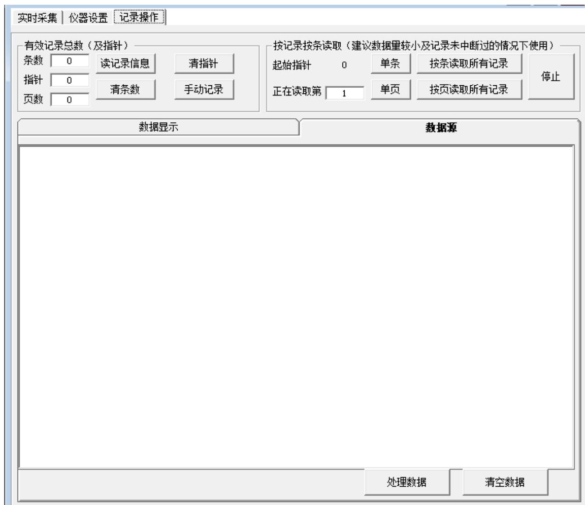
通过“单条”或“按条读取所有记录”可以将设备里的有效数据，读到软件里。通过处理数据后，在“数据显示”栏目，可以看到已处理好的数据，比如：
