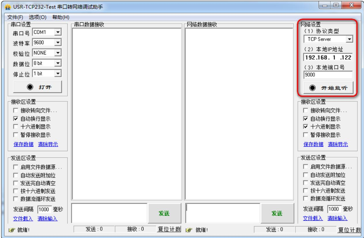
右侧网络设置：协议类型选择和模块设置相同；本地IP和路由器设置转发规则相同，
