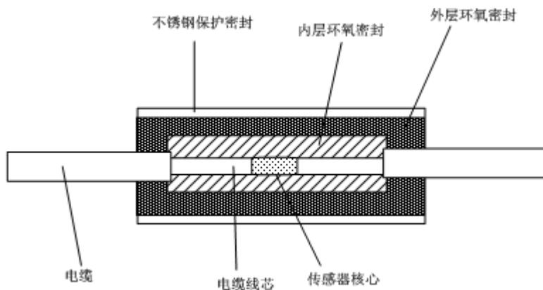
如上图所示, SCA1000 采用三层密封防护的防水工艺, 最外层用不锈钢外壳起保护与密封作用。
