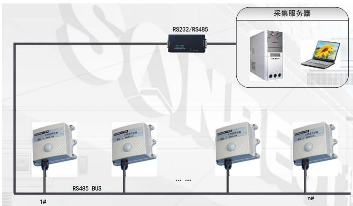
SD2161B 通过 RS485 总线的组网方式,可以将通讯距离延长到最长 1200 米,可以有效解决最简连接的距离过短问题。
