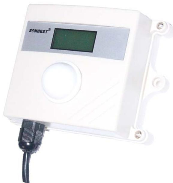
SD2161B 宽量程光照度传感器为 RS485 总线式光照度传感器, 采用 RS485 接口, 标准 MODBUS-RTU 协议, 可实现多点同时监测, 组网并远传。适用于各种场所, 尤其适用于农业大棚、城市照明等场所。
