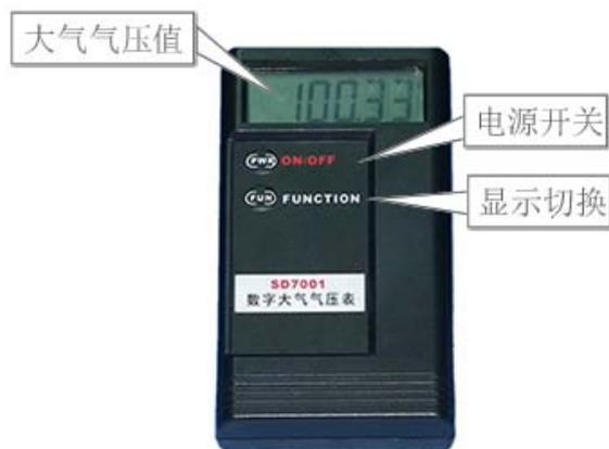
如上图所示，本仪器主要有电池、大气压力传感器、大气温度传感器、微电脑处理器、液晶显示器、线路板、电子元器件、外壳等组成。
