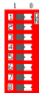
图 3-2 设置地址的拨码开关 S1
