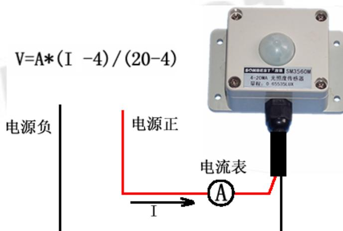
测量电流  $i$ 、量程  $A$  及光照度值  $V$  的关系:
