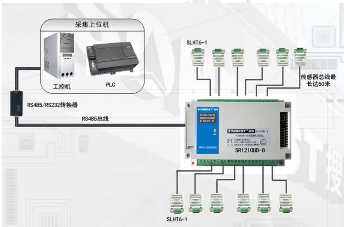
SR1210BD-8 可以接 8 个温湿度传感器，可以直接与 SLHT 系列各种传感器相连接。图示举例与 SLHT6-1 壁挂式温湿度传感器相连接。模块与传感器之间的引线距离最长可达 50 米。SR1210BD 与上位机之间为 RS485 总线，距离最远可长达 1200 米。因模块电源电压为 6-24V 宽范围，故可远程供电，组网更方便。上述方案适用于实时动态采集，由于设备本身是一款高性价比记录仪，设备可以循环保存 1600 多条记录。即使掉电，掉电前的重要数据都会存储，并可以
