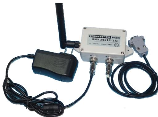
如上图所示，将RS232串口线直接接到台式机的RS232串口，并接通电源。然后即配使用无线传感器配送的软件进行测试（软件请到公司网站下载：[www.sonbest.com](http://www.sonbest.com)）
