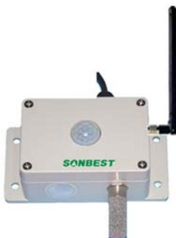
SD3390 ZIGBEE 无线二氧化碳、光照度、温度、湿度一体传感器为 ZIGBEE 无线总线式传感器，是针对农业生产过程中环境监测而设计的专用传感器，内置核心传感器全部为进口器件。仪器能够连续监测二氧化碳气体浓度、光照度及环境温湿度等 4 种环境参数，每个参数值都转换成 MODBUS-RTU 标准 ZIGBEE 无线电信号传输给关联设备，本传感器内置了报警接口，可选配超限声光报警设备。
